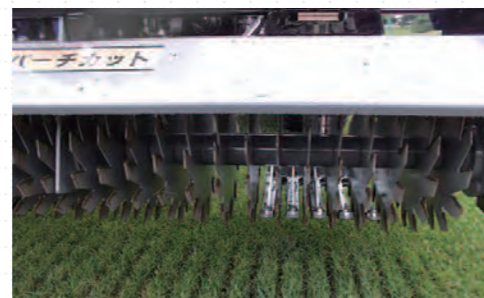
バーチカルカットの実施状況
