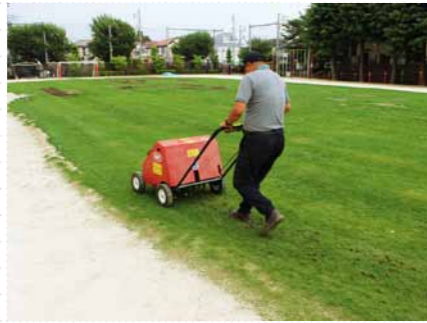
エンジン式の自走式エアレーター。地面が固すぎると、穴を開けられない場合があります。
