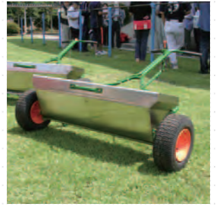
ドロップ式肥料散布機 肥料散布機の横幅の範囲に肥料が散布されます。
