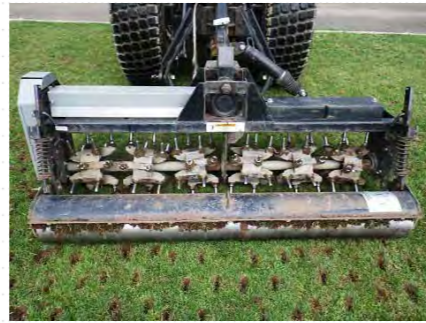
牽引式のエアレーター。写真はパイプロエアレーター。土壌を広くほぐす効果があります。
