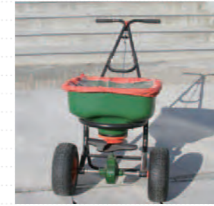
ブロードキャスト式肥料散布機 肥料散布機から片側約1.5m、両側で約3mの範囲に肥料が散布されます。
