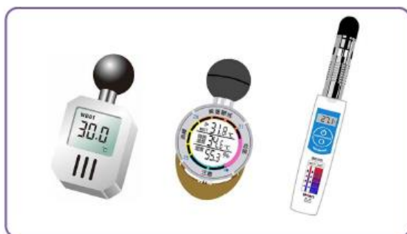
図2 携帯型 (ハンディータイプ) の電子式暑さ指数 (WBGT) 計
