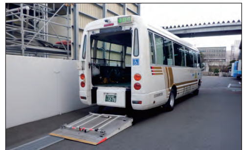
【都立肢体不自由特別支援学校のリフト付きスクールバス】
